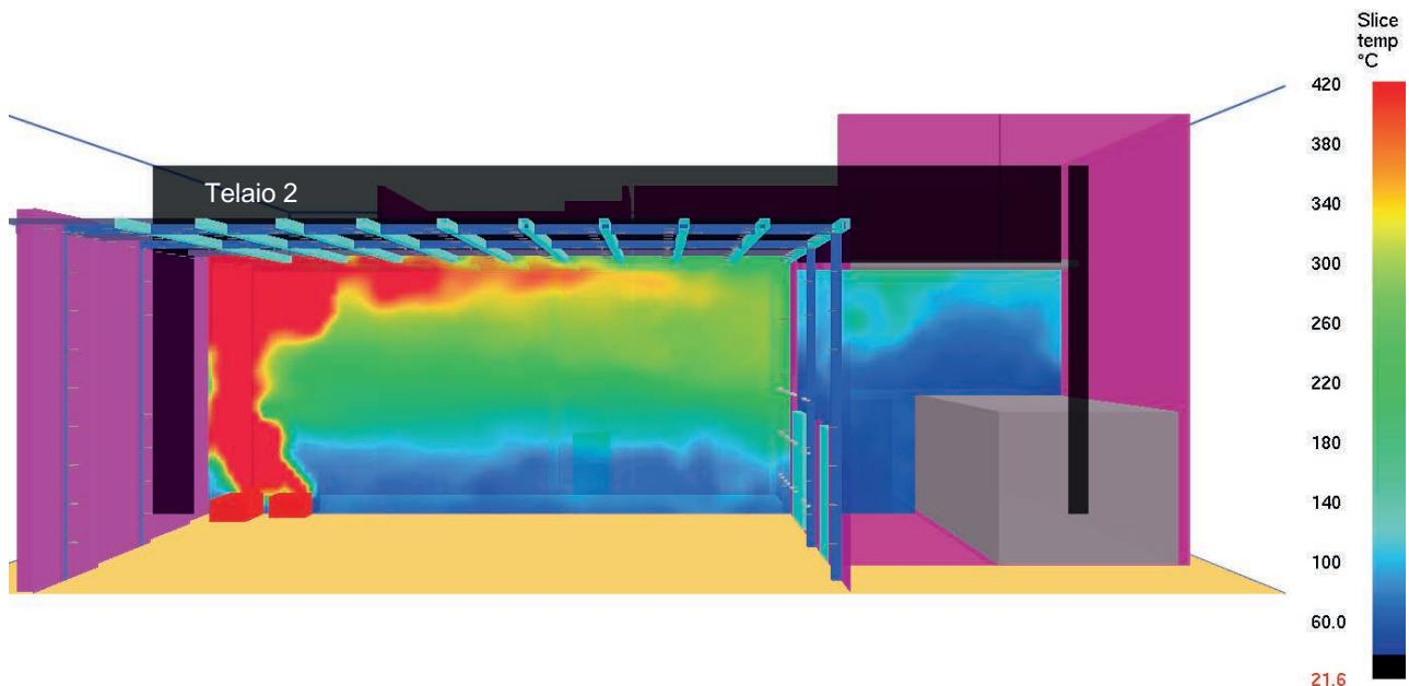
**SLICE DI TEMPERATURA A  $X = 5,50 \text{ m}$  IN CORRISPONDENZA DEL TELAIO 2,  $T = 1000 \text{ s}$**
