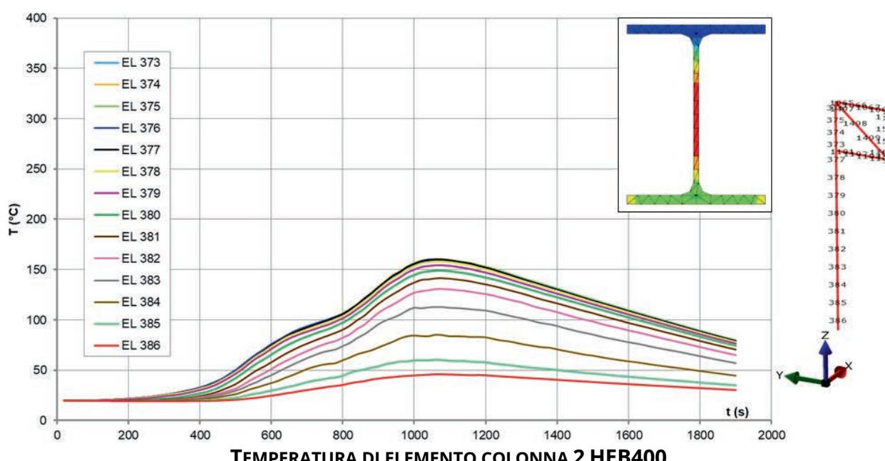
È inoltre interessante valutare la differenza di temperatura tra corrente superiore ( $z=7\text{ m}$ ) e corrente inferiore ( $z=5,50\text{ m}$ ) e la differente temperatura di elemento nei correnti superiore man mano che ci sia allontana dall'asse dell'incendio.
