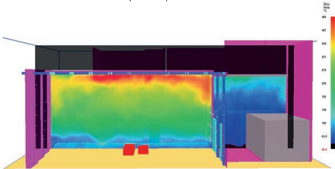
SLICE DI TEMPERATURA TELAIO 2, T = 1000 s
