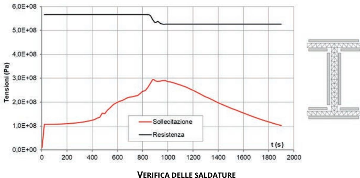
Si riporta di seguito anche la verifica nel caso di diagonale della travatura del *telaio 2*.
