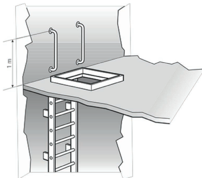
Scala verticale passante attraverso una apertura
